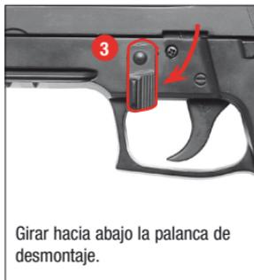
Girar hacia abajo la palanca de desmontaje.
