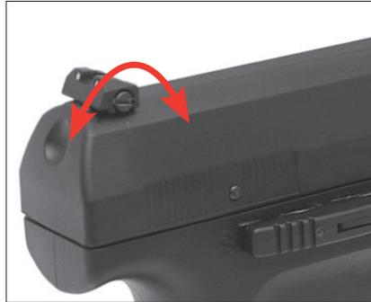
Tourner la vis de la hausse vers la gauche en cas de tir trop à gauche et vers la droite en cas de tir trop à droite.
