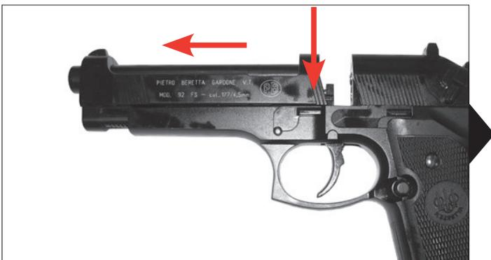
Appuyer sur le levier de déverrouillage. La culasse s'ouvre automatiquement.
