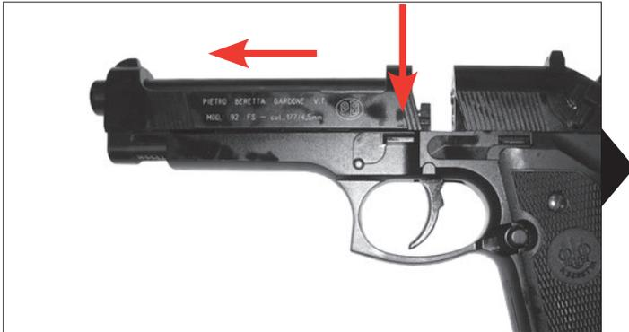
Appuyer sur le levier de déverrouillage.
