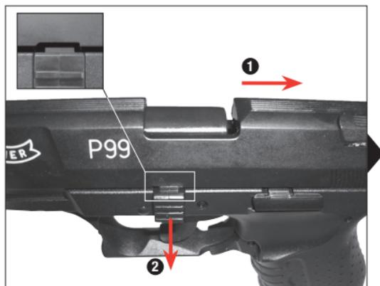
Innenliegenden Hahn spannen durch zurückziehen des Schlittens.
