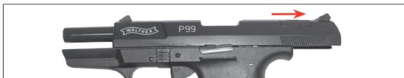
Durch zurückziehen des Schlittens und anschließendem nach vorne schnellen, wird die Patrone in den Lauf transportiert. Die Waffe ist nun geladen.
