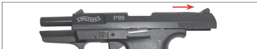
При оттягивания затвора назад и последующем его скольжении вперед патрон подается в ствол. Оружие теперь заряжено.
