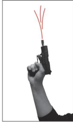
Fişek kutusunu vidalayın. Silahı tarif edildiği şekilde kuru sıkı fişekler ile doldurun. İşaret fişegini açık (siyah) kovan ucu önde olacak şekilde atış kutusuna yerleştirin. Silahı ateşleme esnasında dikey olarak başınızın üzerinde tutun.
