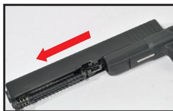
D'abord, enlevez le chargeur. Puis glissez la culasse en arrière (1) et en même temps, appuyez sur le verrou de culasse (2) des deux côtés. Poussez ensuite la culasse vers l'avant (3) pour l'ôter.
